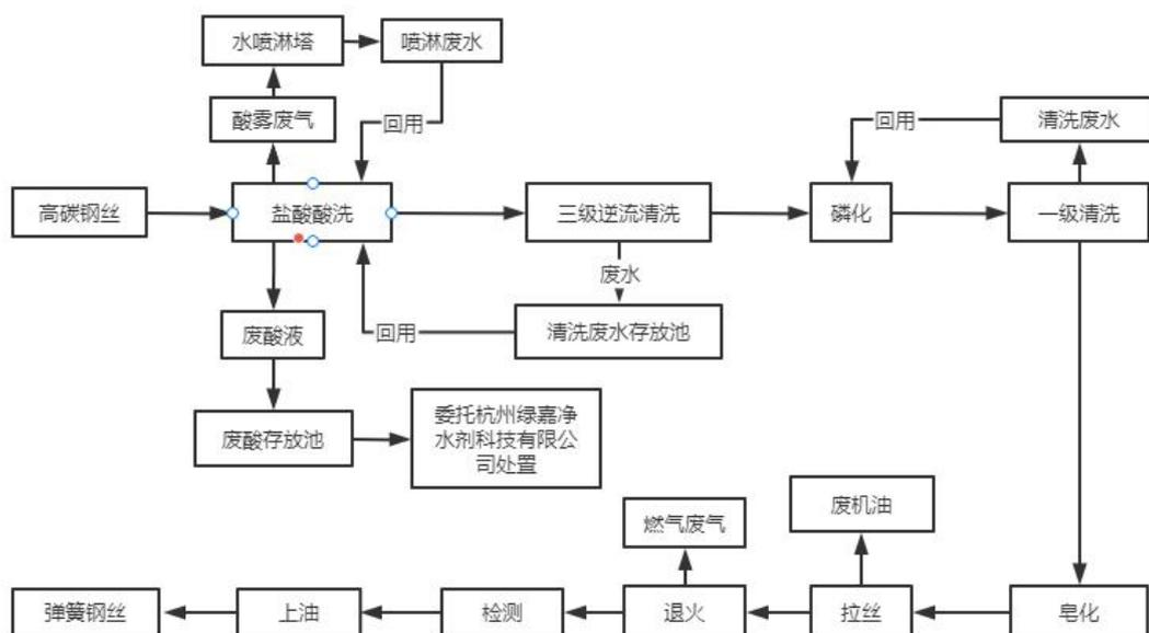
图 4-1.2 弹簧钢丝生产工艺流程
