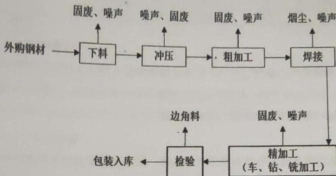
图 1 工艺流程及产污环节图
